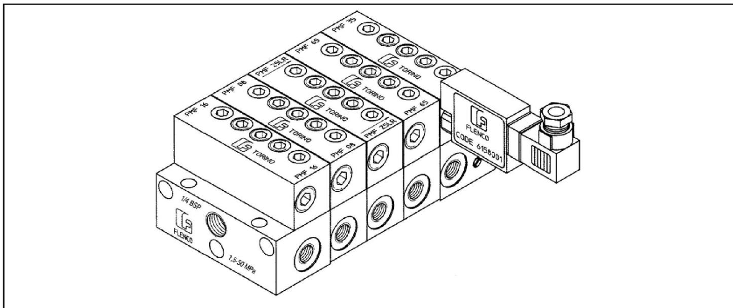
Il sistema modulare **PMF** rappresenta, nel campo della lubrificazione centralizzata, la soluzione tecnica più avanzata che consente: precisione e garanzia di dosaggio, flessibilità nell'assemblaggio dei blocchetti, intercambiabilità dei dosatori, possibilità di intervento e modifica sul blocco in qualsiasi situazione e facilità di manutenzione.
